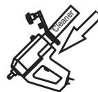
Reinigerkartusche in die Pistole einlegen. Welche Reinigungsmasse für den verwendeten Klebstoff geeignet ist, erfahren Sie beim Klebstoffhersteller.
