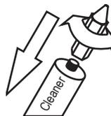
Düsenadapter auf das Schraubgewinde der Reinigerkartusche schrauben.
