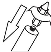
Schrauben Sie den Düsenadapter und die Düse auf die Kartusche auf.
